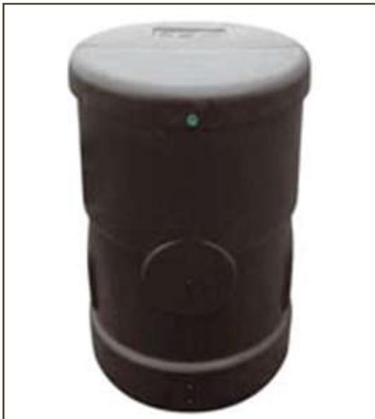
Caja de distribución de polietileno de alta densidad, de rápida y sencilla instalación. Formada por un cuerpo cilíndrico, con zonas planas para poder taladrar de uno a cuatro agujeros (viene ciega de fábrica), y tapa.
