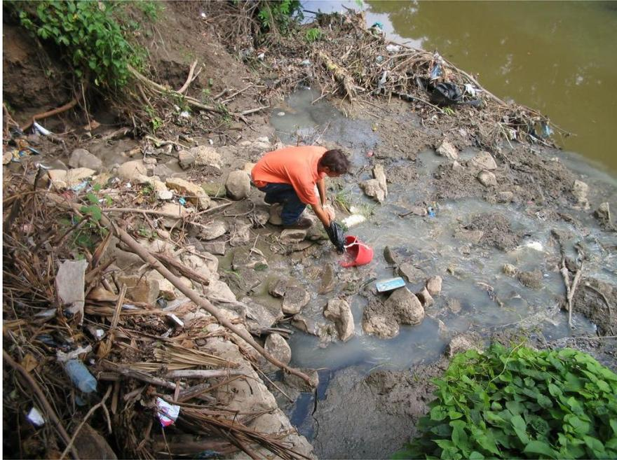
Fotografía 3. Toma de Muestra 3, línea de alcantarillado rota, paralela al Arroyo grande de Corozal, vía a Betúlia, Municipio de Corozal
