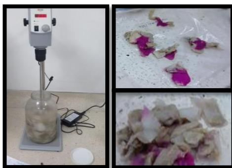
Figura 6. Proceso de desencalado de las muestras de descarnes.
