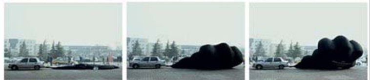
Experimento para calcular la cantidad de gas emitida por un vehículo, sin acelerar el motor, en media hora ( http://detengamosesto juntos.blogspot.com )
