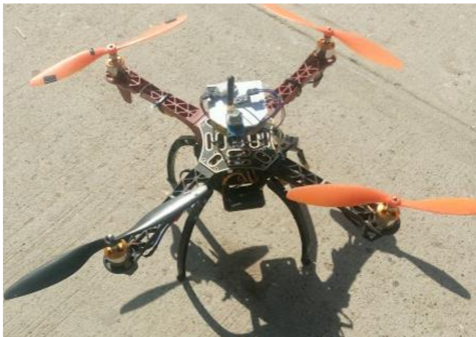
Figura 28: aeronave no tripulada con sistema para la medición y monitoreo de calidad del aire
