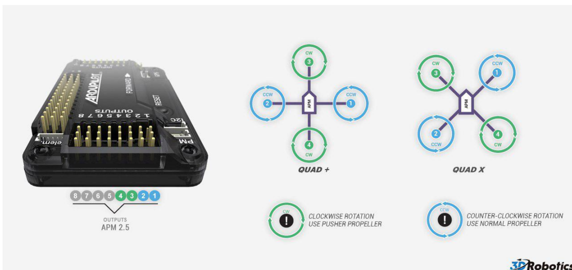
Figura 20: Diagrama de posición para los ESC en la controladora APM 2.6
