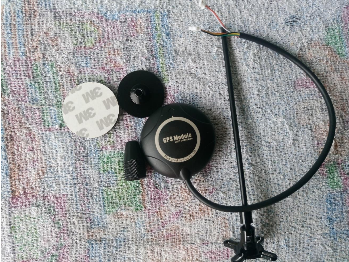
Figura 14: GPS externo con brújula interna
