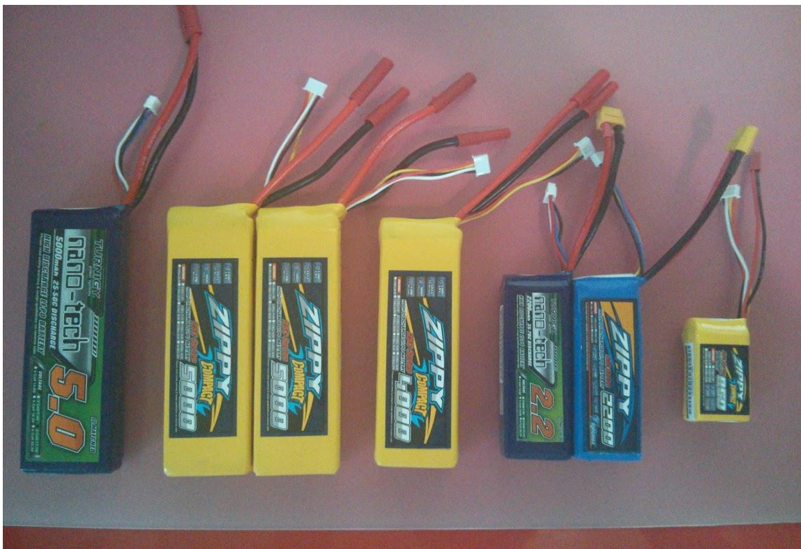
Figura 18: Distintas baterías Lipo con capacidades de 5000mAh, 4000mAh, 2200mAh y 850 mAh
