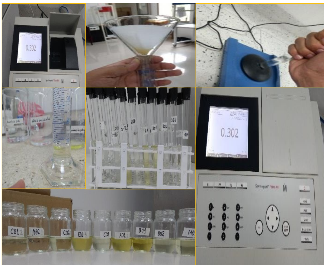
Figura 6. Montaje de la prueba de hidroximetilfurfural.
