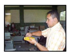
Fig. 27. Diámetros de las mazorcas tomadas con un pie de rey Fuente: Nasly Contreras – Teofilo Naranjo.
