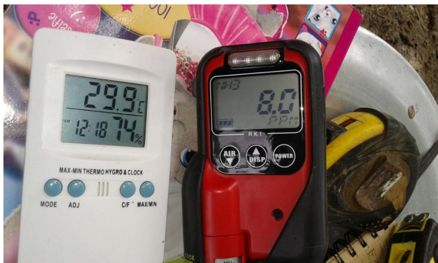
Anexo A. Equipos de medición de amoníaco
