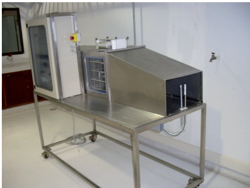
Figura 1. Secador de bandejas a escala de laboratorio.
