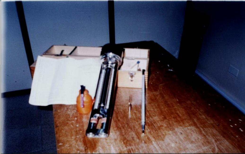
Para la toma de humedad relativa se utilizó un psicrómetro de aspiración y para la toma de temperatura se utilizaron termómetros de mercurio, ambientales.
