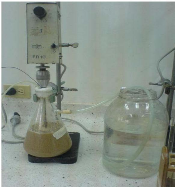
**Figura 5.** Montaje de un biorreactor experimental a nivel de laboratorio, para la obtención de alcohol etílico de las variedades de ñame Burrión (*D. alata*) y Alemán (*D. rotundata*).
