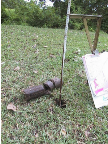
Figura 5. Método de Porchet “el Rosario”
